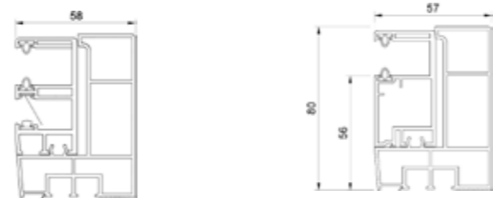
Einseitige Führungsschiene (PVC) - RS Revision von außen. MK933 + MK9760
